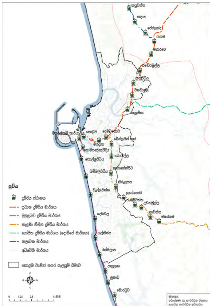
රූප සටහන 6.16: විදුලි දුම්රිය මාර්ග සහ නව්‍යකරණය සඳහා යෝජිත දුම්රිය මාර්ග පද්ධතිය
