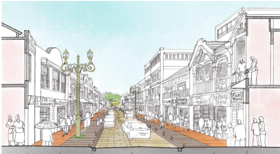
මූලාශ්‍රය : විසල් මහනුවර සංවර්ධන සැලැස්ම - ජයිකා ආයතනය (C) මාර්ග වර්ගය 3 - පටු මාර්ග සටහන 2.4.6 පටු මාවතක හරස්කඩ සටහන (කාසල් පටුමග)
