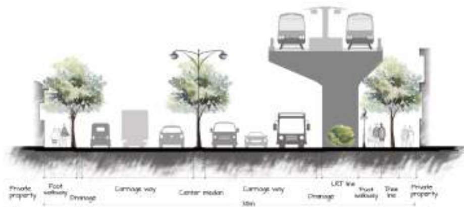
රූපය 5.3: පී 1 මාර්ග කාණ්ඩයේ සහ සැහැල්ලු දුම්රිය මාර්ගයේ නිර්දේශිත සාමාන්‍ය හරස්කඩ මූලාශ්‍රය : බස්නාහිර පළාත් අංශය සහ පර්යේෂණ හා සංවර්ධන ඒකකය, නාගරික සංවර්ධන අධිකාරිය - 2018
