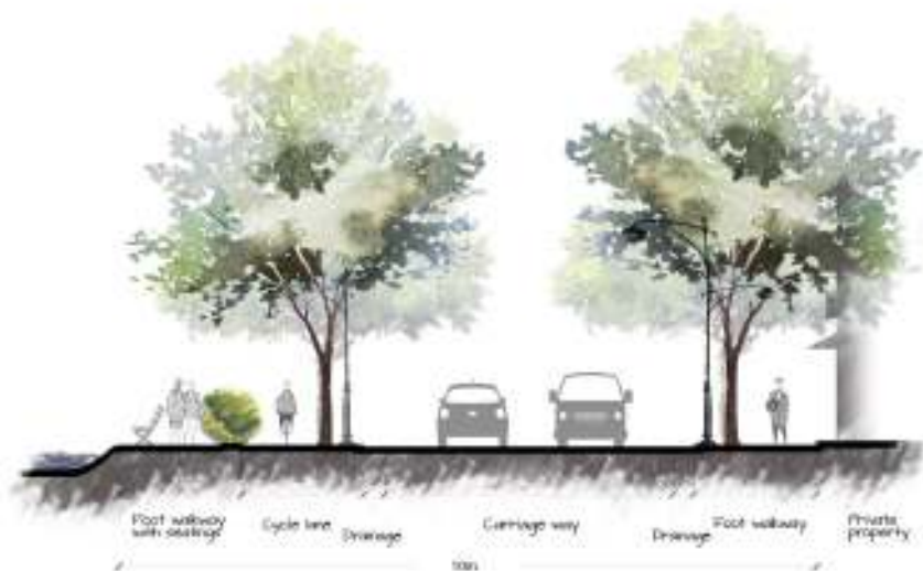
රූපය 5.8: පී 6 මාර්ග කාණ්ඩයේ නිර්දේශිත සාමාන්‍ය හරස්කඩ මූලාශ්‍රය : බස්නාහිර පළාත් අංශය සහ පර්යේෂණ හා සංවර්ධන ඒකකය, නාගරික සංවර්ධන අධිකාරිය - 2018
